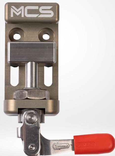
Die MCS Halteklaue ist eine Klemmklaue zur schnellen Anbringung von medizinischen Geräten und Zubehörteilen an Normschienen. Der Spannhebel ermöglicht ein schnelles Verlasten an den Normschienen (25mm x 10mm).
