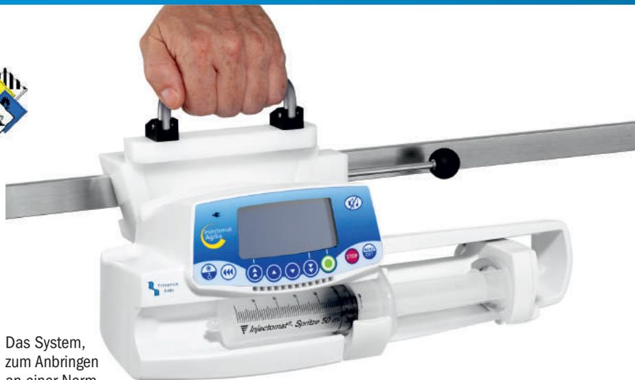
Das System, zum Anbringen an einer Normschiene, beinhaltet einen Spannungswandler zum Anschluss an das Bordnetz. Mit Entnahme der Agilia-Pumpe schaltet das System automatisch auf Akkubetrieb um. Somit stehen Ihnen die hervorragenden Produkteigenschaften der Injectomat Agilia nun auch mobil zur Verfügung.
