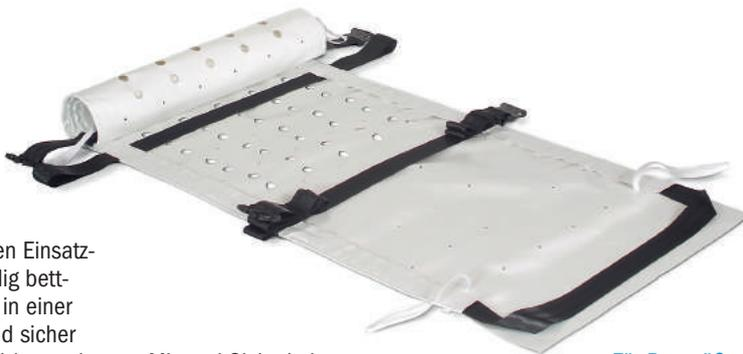
Mit zwei Sicherheitsgurtschnallen wird bei einer Rettungssituation über die Querseite der Matratze einfach und schnell eine Steckverbindung hergestellt und der Gurt mit dem losen Ende an- und dann so fest wie möglich zugezogen. So entsteht für den liegenden Menschen eine sichere, schützende U-Form der Matratze. Das Evakuierungstuch eignet sich besonders zur Fensterrettung.
